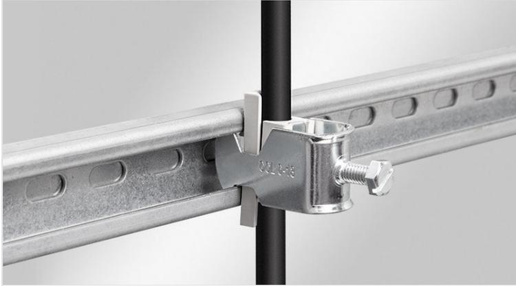
Las abrazaderas de cable se caracterizan por un alto rango de sujeción y una gran flexibilidad. Ideal para alivio de tensión en el carril C con dimensiones de apertura de 16-17 mm. El pisador del cable está asegurado por un mecanismo de bloqueo y no puede deslizarse fuera de la abrazadera del cable. Ofrece rangos de sujeción flexibles de 6 mm a 64 mm.
